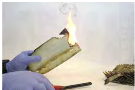
(写真21) 蒸発板の燃焼状況
