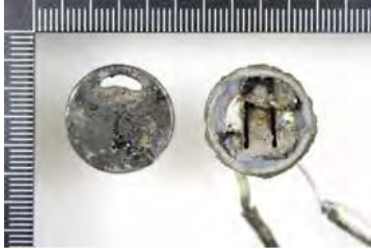
(写真19) サーモスタット内部の焼損状況
