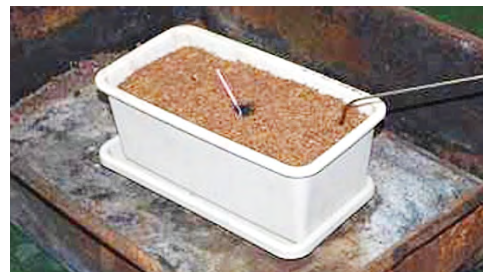
写真9 内部温度を測定
