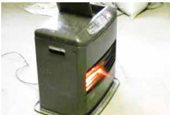
写真11 炎が吹き出す状況
