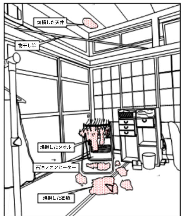
図1 消防隊現着時の状況
