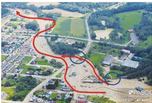
写真2 ペケレベツ川の河岸決壊状況、左)石山橋周辺（9/1撮影、左右岸の連続的な河岸決壊状況）（PASCO 提供）、右)石山橋下流（9/6調査団撮影、河岸決壊の状況）
