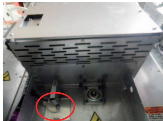
写真12 エアフローダンパー
