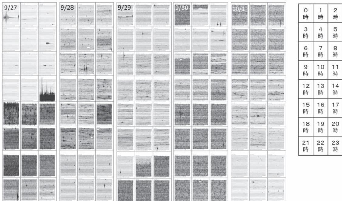
図2 噴火した9月27日から10月1日にかけての火山性微動の記録。山頂南東側3kmの位置にある気象庁の地震計記録。9月27日11時台から噴火に伴う微動が記録されている。火山性微動の震幅は徐々に減衰していったが、29日の19時頃から急に震幅が大きくなり、9月30日の深夜にかけて大きな震幅が記録されている。10月1日の未明から徐々に震幅が小さくなっていることが分かる。
