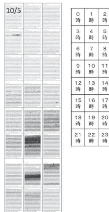
図3 土石流と判断できた震動。10月5日16時台に記録された震幅の大きな震動は土石流が火口付近から谷に沿って流れたものと推測される。
