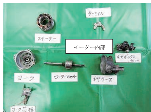
モーター内部の焼損状況
