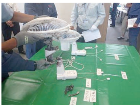
モーターカバーの焼損状況
