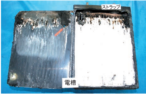
写真6 電槽側板の孔の位置とストラップ及び陽極板が溶融している位置の状況
