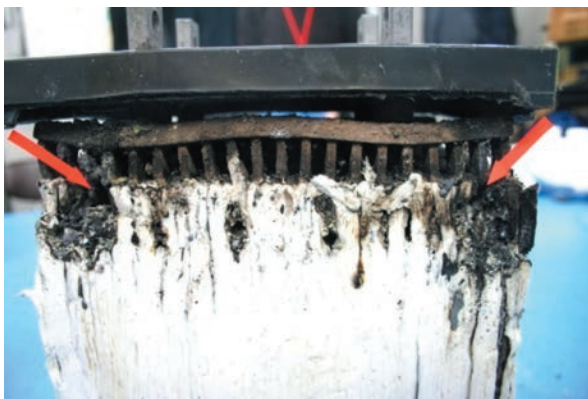
写真7 制御弁式措置鉛蓄電池の陽極端子側上部にある櫛状のストラップの状況
