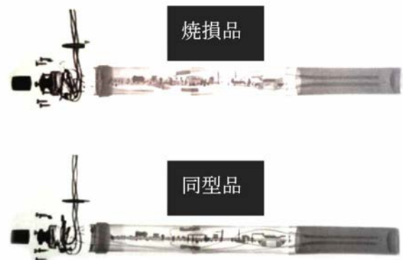
写真2 ヒーター内部の状況
