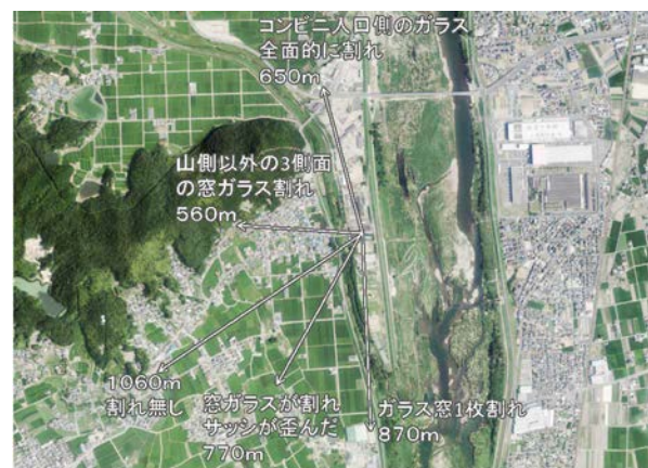
図5 爆風による窓ガラスの被害状況 2), 3)
