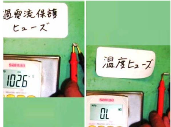
写真17 ヒューズの導通測定状況
