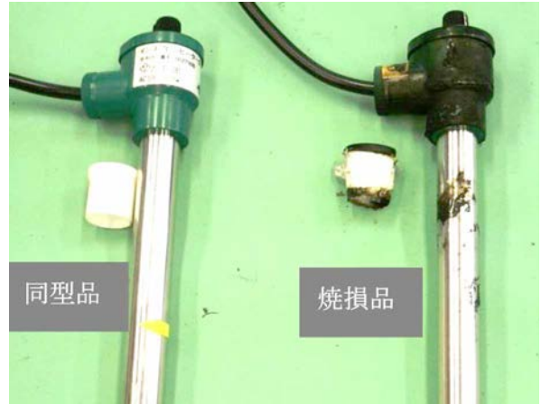
写真9 ヒーターアダプターの状況
