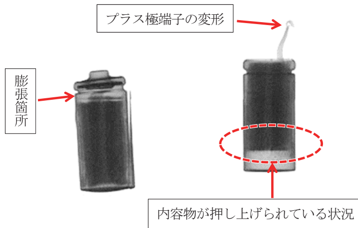
【写真8 県警科学捜査研究所で発見された焼損電池】
