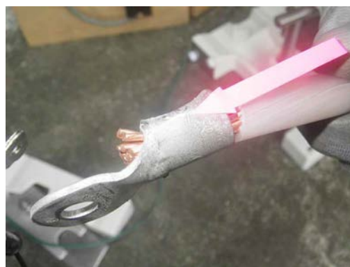
写真22 実験1回目丸型圧着端子の状況
