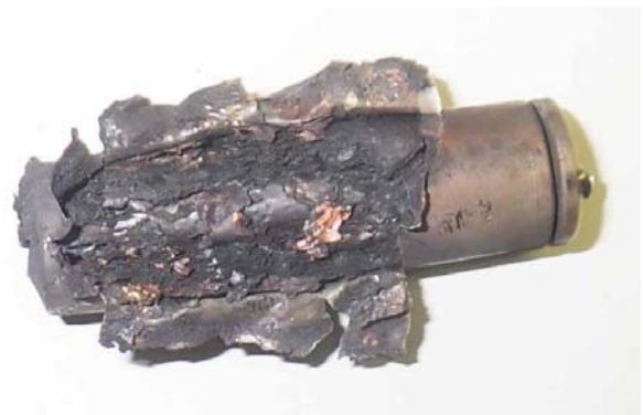
写真15 内部が露出したリチウムイオン電池
