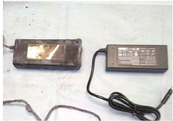
写真4 ACアダプターの同型品との比較
