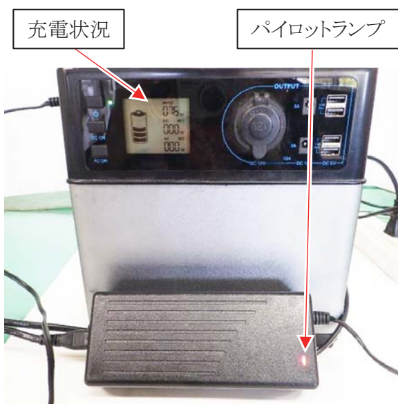
写真16 パイロットランプ及び充電状況表示
