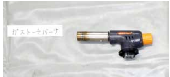
写真 8 焼損したトーチバーナ
