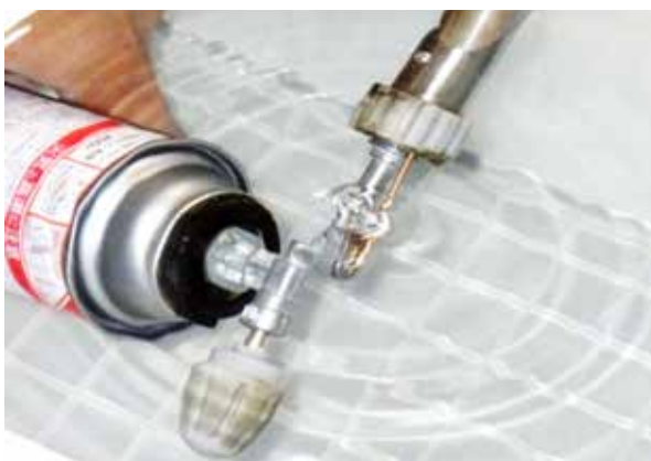
写真4 漏洩試験の状況
