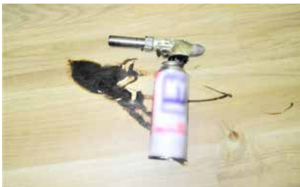
写真3 焼損したトーチバーナと床面
