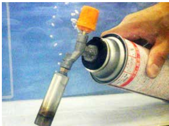
写真9 漏洩試験の状況
