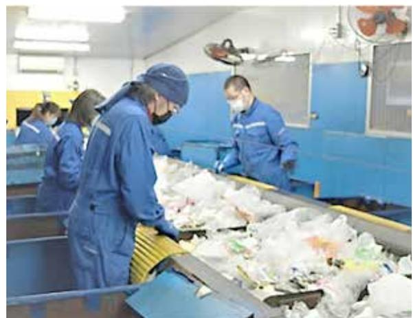
図4 プラスチック製容器包装廃棄物の手選別の様子<sup>17</sup>
