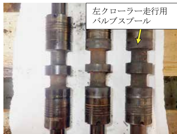
写真13：バルブスプールの状況
