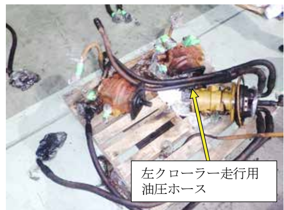
写真9：油圧ホースの状況
