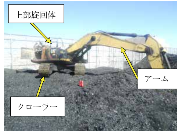
写真3：上部旋回体の状況
