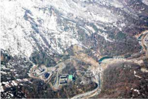
写真-3 2008年4月20日に発生した岩手県雫石町葛根田の地すべり。発生した地すべりの背後地形をみるとかつて発生した大きな地すべり地の末端部に位置していることがわかる (国土交通省提供)
