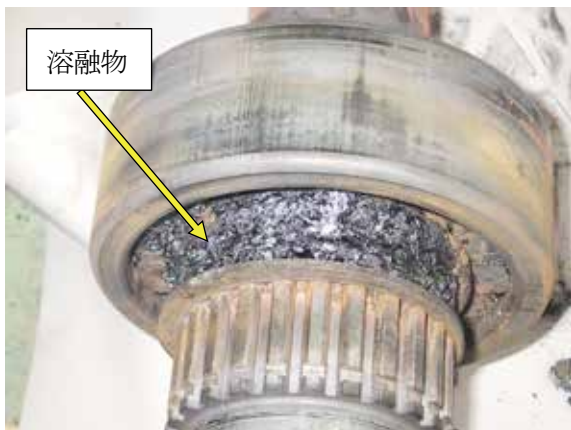
写真18：シャフトベアリング内側の状況
