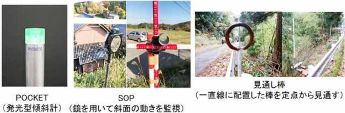
写真-1 高須町で使用した OSV 観測機器
