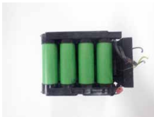
【写真11 バッテリー分解後】
