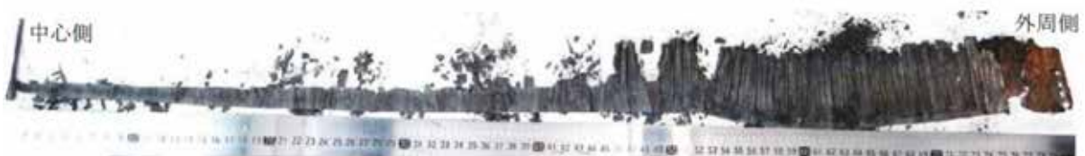
【写真10 電池セルBの電極体の展開状況】
