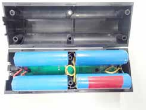
【写真13 バッテリー分解後】
