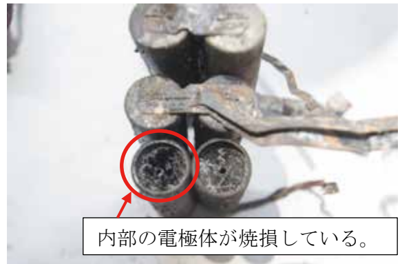
【写真6 焼損した電池セル】
