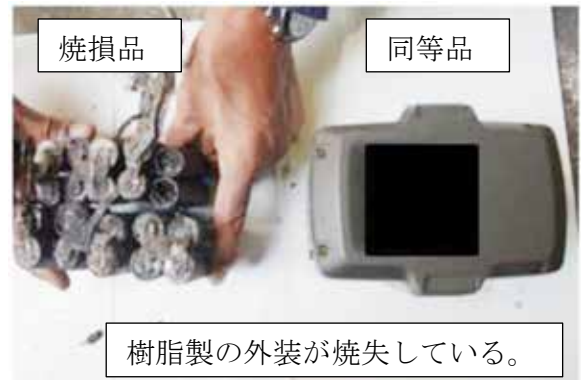
【写真5 バッテリーの焼損状況（同等品との比較）】
