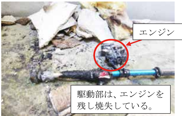
【写真3 刈払機の焼損状況】
