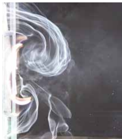
図5 全実験条件下で最も強い渦を煙で可視化した写真
