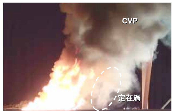
図8 CVPの最下部である可能性が高い「火災風下の定在渦」
