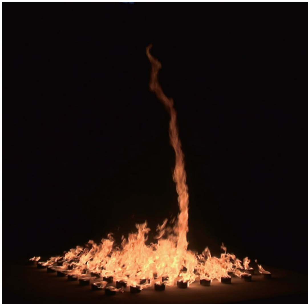
実験で再現した火柱状の火災旋風
