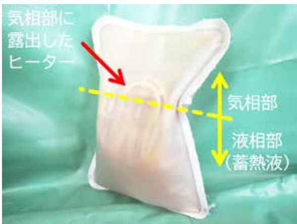
【写真16 気相部に露出したヒーター】
