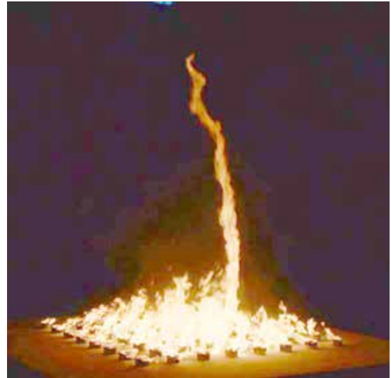
図1 実験で再現した火柱状の火災旋風
