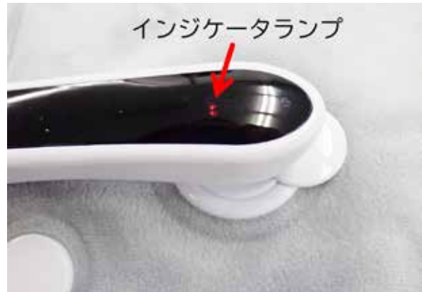
【写真8 蓄熱時のインジケータランプの点灯】
