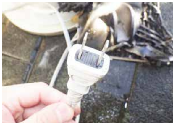
【写真2 焼損品：差し刃】
