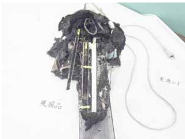
【写真5 焼損品：前カバー側】
