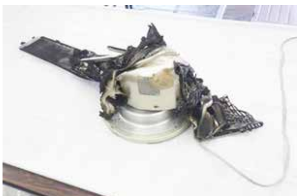
【写真6 焼損品：後カバー側】
