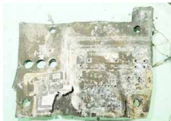
【写真18 焼損品：操作基板】
