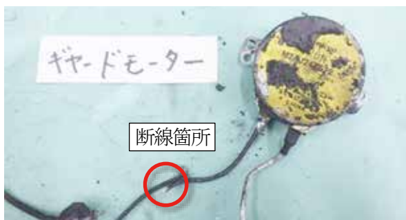
【写真14 焼損品：ギヤードモーター】
