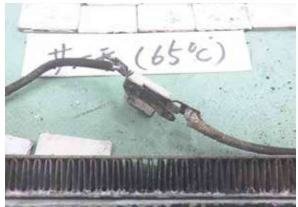
【写真11 焼損品：サーモスタット】
