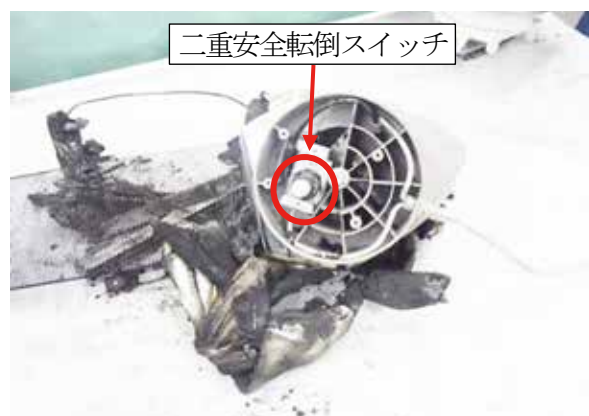
【写真8 焼損品：二重安全転倒スイッチ】
