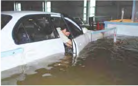
図3 開閉式ドアの車からの避難実験
