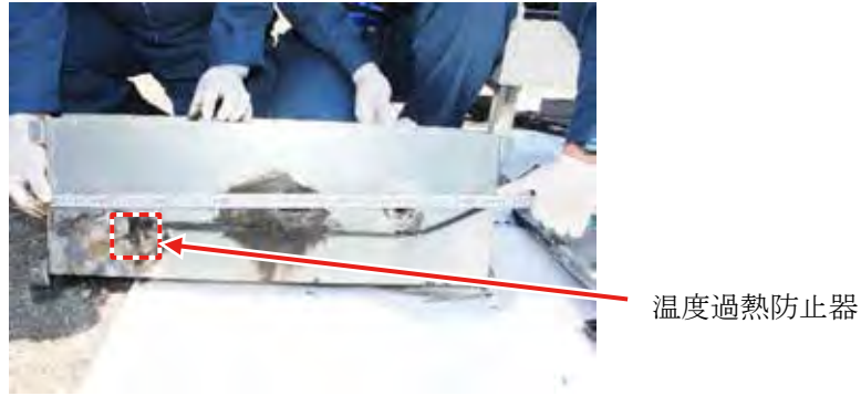
(写真11) 蒸発皿 2 段目底面 (裏面) の状況
