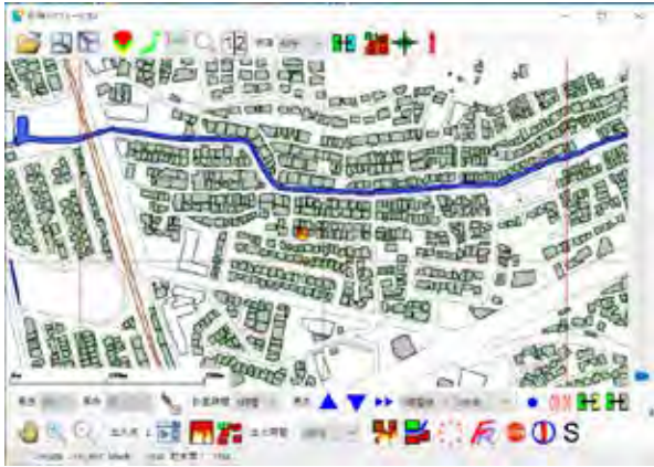
図1 市街地火災延焼シミュレーションソフトウェアの画面例
