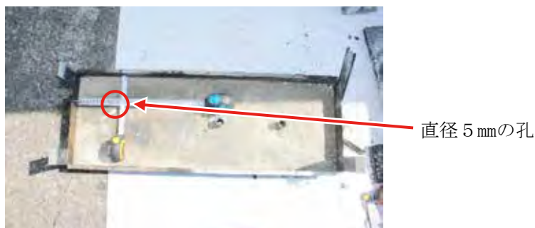
(写真10) 蒸発皿2段目上面(表面)の状況
