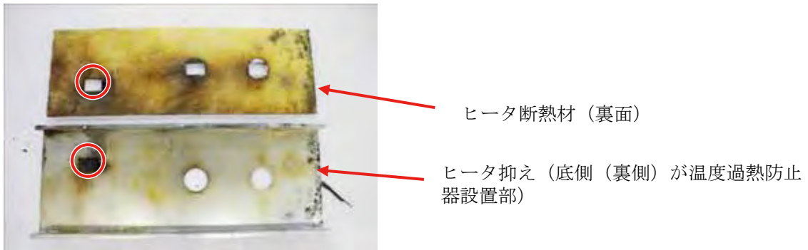
(写真13) 蒸発ヒータ及び断熱材の状況
