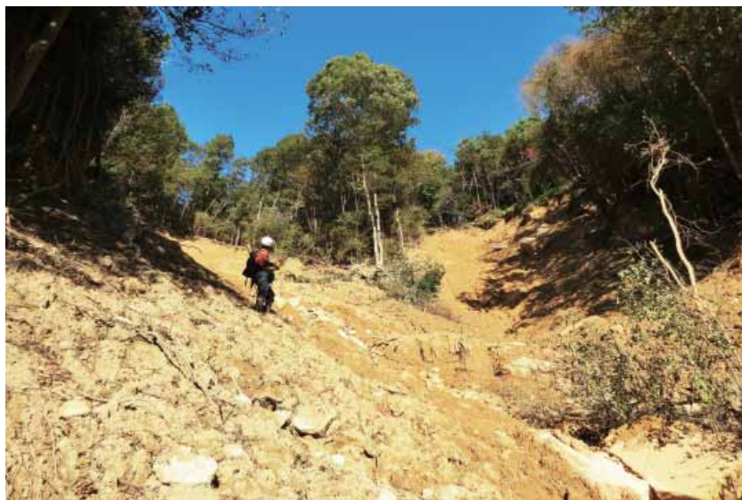
写真1 県営緑丘住宅上流の崩壊源頭部全景。表層崩壊であり、岩脈（斑状流紋岩）が露出する。
