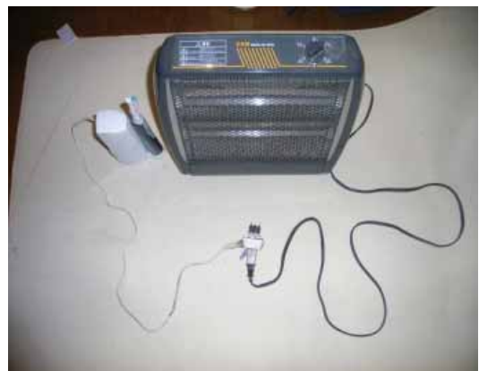
写真 電気ストーブ及び電動歯ブラシの接続状態
