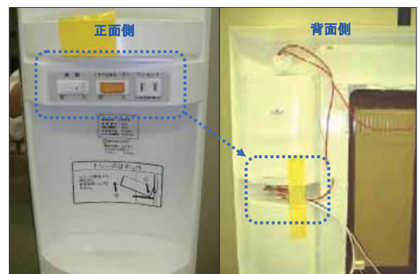
写真 スイッチ部裏側の配線収納スペース(同型品)
