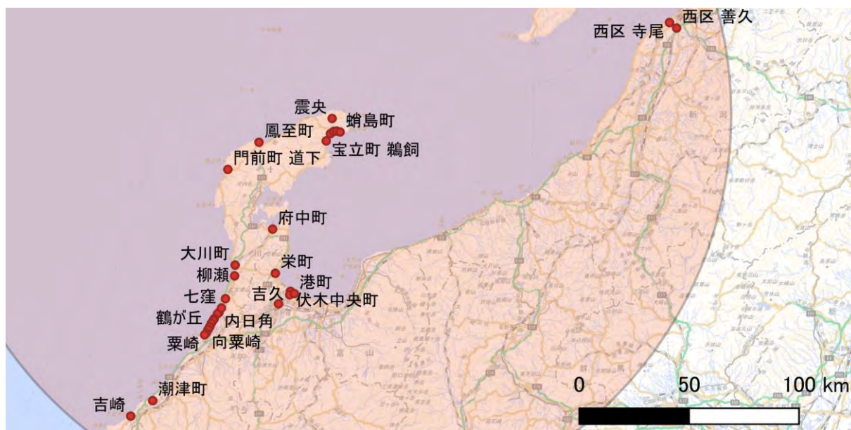
図1 令和6年能登半島地震の液状化限界震央距離 R と主な液状化確認地点（筆者調べ）
