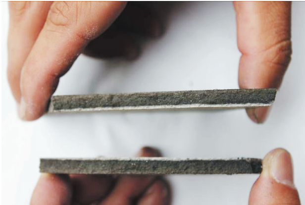
炭化した石膏ボード（出火箇所付近から採取）
