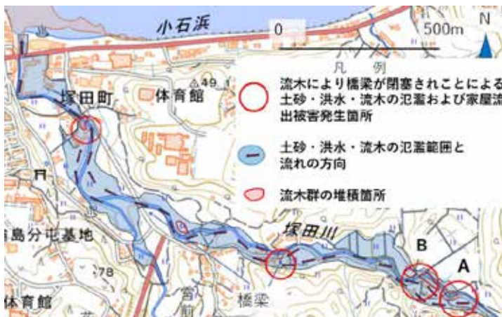
図8 輪島市塚田川における流木による橋梁閉塞に伴う土砂・洪水・流木の氾濫（2024年9月）、1/25,000地形図（国土地理院）に加筆
