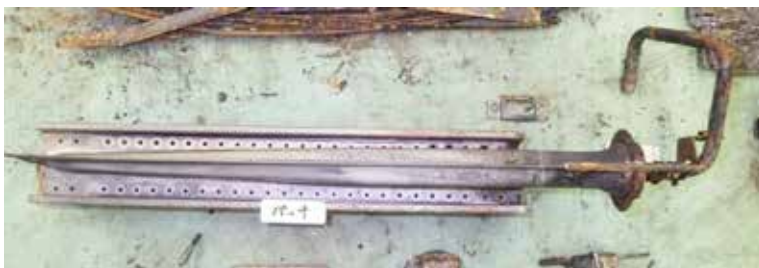
写真13 バーナー及びバーナー内部
