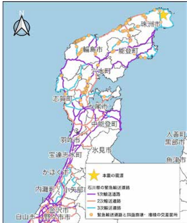
図2 石川県の緊急輸送道路と斜面崩壊・堆積の交差箇所。石川県の緊急輸送道路は国土数値情報のデータ 5) 、斜面崩壊・堆積は国土地理院のデータ 6) を用いて作成した。
